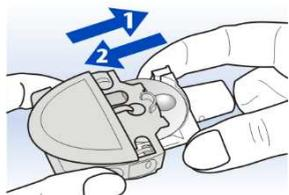
Dadurch dreht sich die Drehscheibe bis zur nächsten Blisterkammer.
