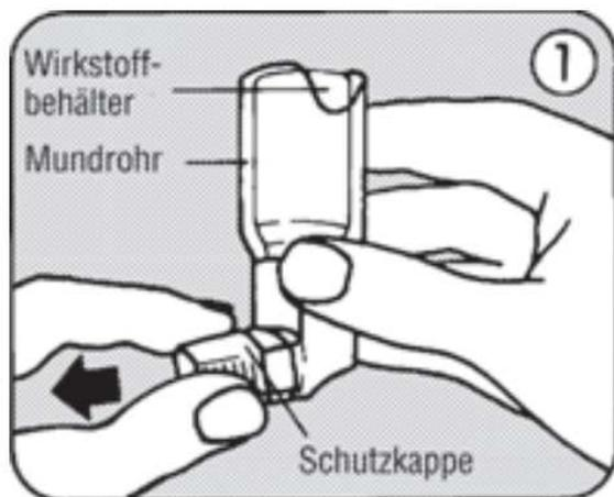
1. Durch leichtes Zusammendrücken der Seitenflächen die Schutzkappe vom Mundrohr entfernen (Abb. 1).
