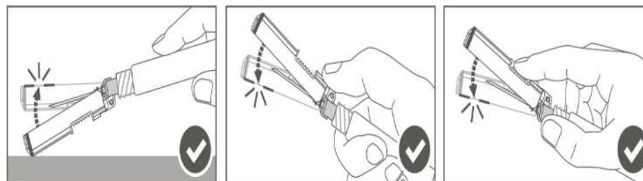
**Schritt 5:** Überprüfen Sie die Aktivierung des Schutzschildes visuell. Der Schutzschild muss **vollständig verriegelt (aktiviert)** sein, wie in der Grafik C gezeigt.
