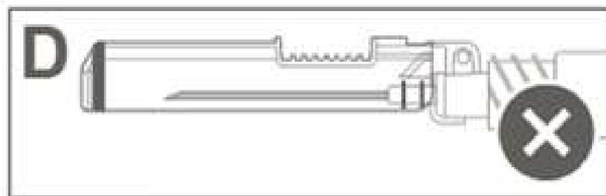
**Vorsicht: Versuchen Sie nicht, die Sicherheitsvorrichtung zu entriegeln (deaktivieren), indem Sie die Kanüle aus dem Schutzschild herausdrücken.**
