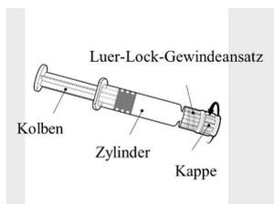
Halten Sie die Spritze am Zylinder, nicht am Kolben. Drehen Sie die Spritzenkappe entgegen dem Uhrzeigersinn ab.
