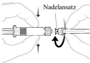
Um die Nadel anzubringen, verbinden Sie den Nadelansatz mit dem Luer-Lock-Gewindeansatz und drehen Sie um eine Vierteldrehung im Uhrzeigersinn, bis die Nadel spürbar einrastet. Ziehen Sie den Spritzenkolben nicht aus dem Zylinder. Falls dies passiert, darf der Impfstoff nicht verabreicht werden.
